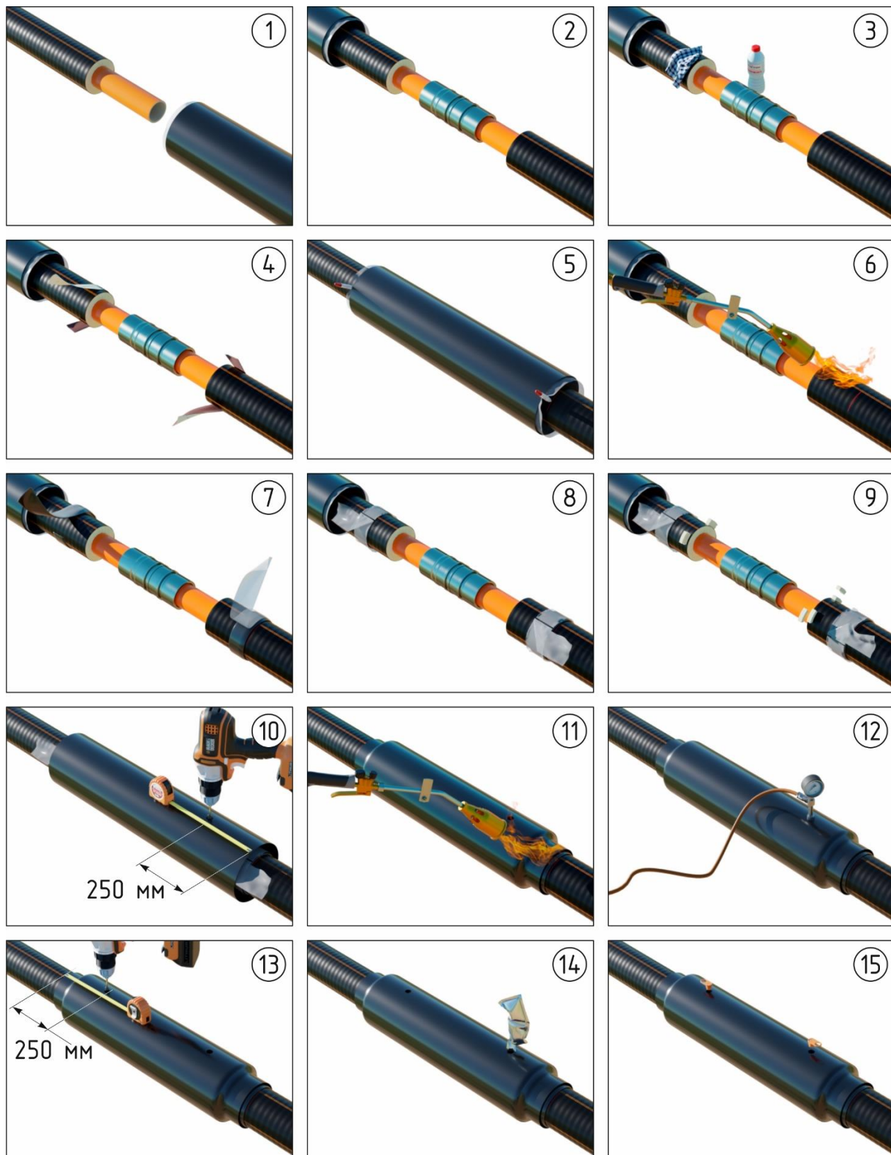
Рис. 5.3.1. Порядок проведения работ по изоляции стыка (начало)
